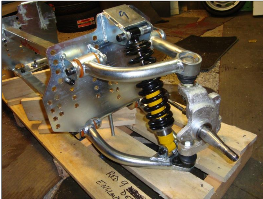
Figure 32 : Exemple de suspension à bras triangulés muni de combiné-fileté
