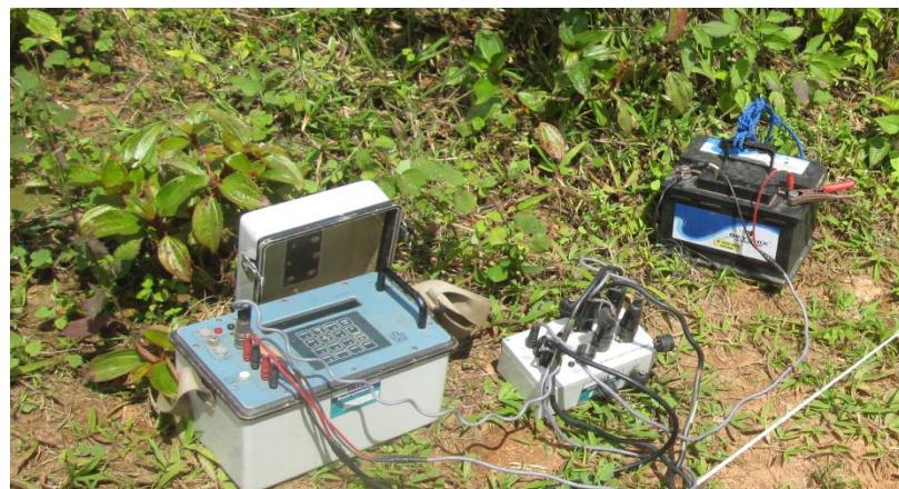
**Photo 3 : Résistivimètre Syscal R1 et ses accessoires**
