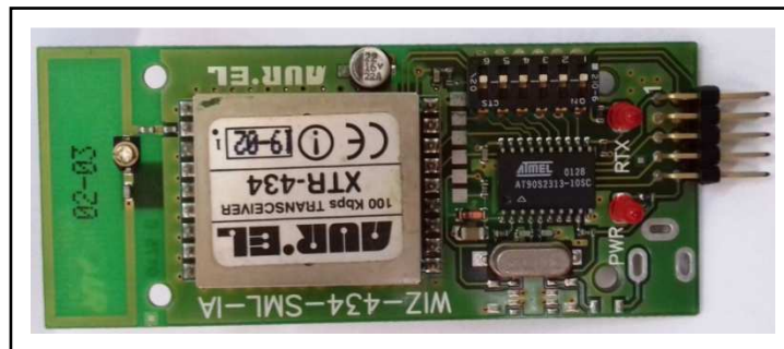
Figure 5.28 : La photo du transmetteur radiofréquence de 434 MHz "WIZ-SML-IA"
