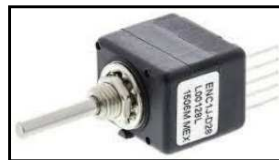
Figure 5.8 : Photo du codeur quadratique HTO ENC1J-D28-L00128
