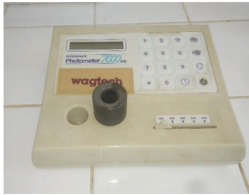
Photos 2: Photomètre portable Palintest 7000 SE.
