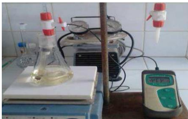
Photos 1: pH-mètre de marque Eutech Instrument, EcoScan pH 5.
