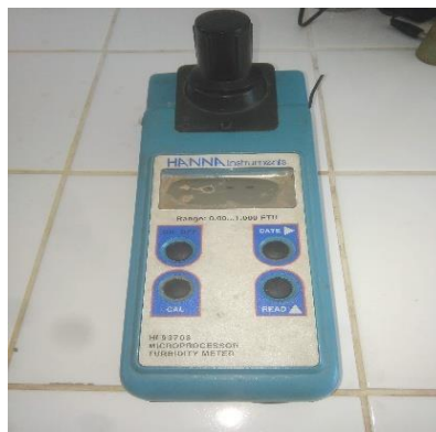
Photos 3: Turbidimètre portable HANNA, HI 93703.
