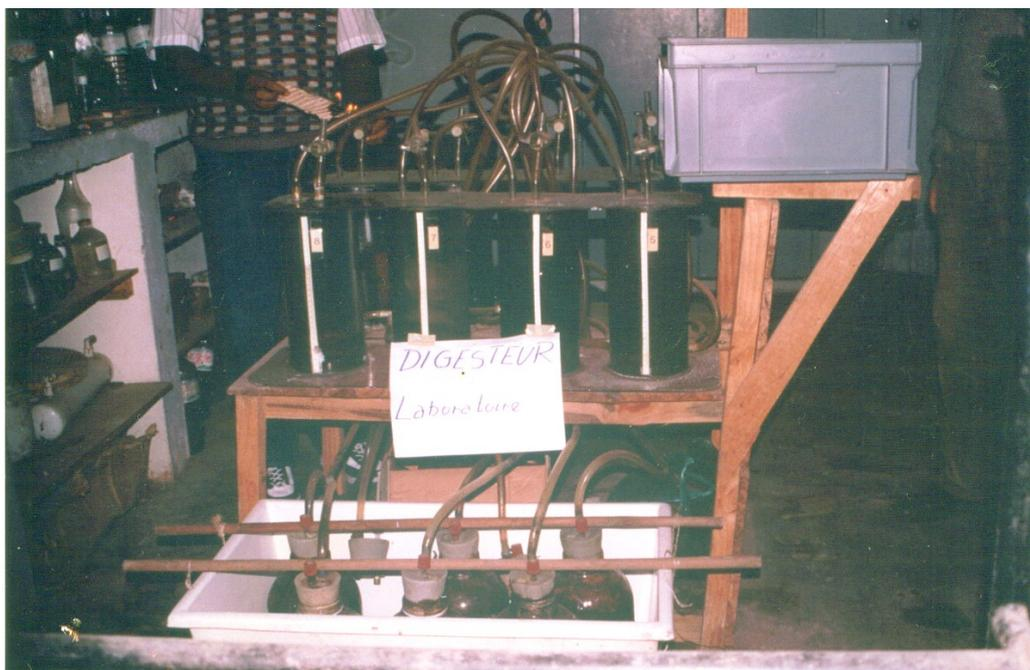
**Figure 10:** Digesteur du Laboratoire
