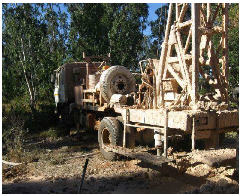
Source : BRGM (2014) Figure 22 : Foreuse sur camion
