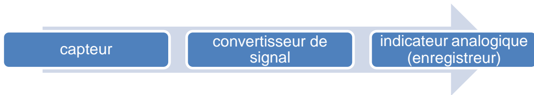
Figure 1 : Diagramme d'un instrument de mesure analogique
