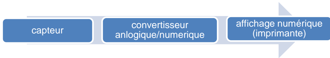
Figure 3 : Diagramme d'un instrument de mesure numérique
