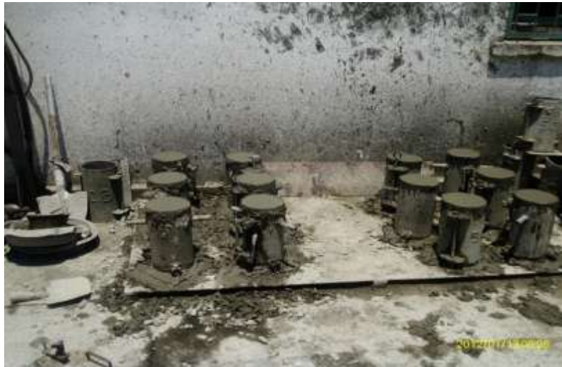
Photo 6 : Moules cylindriques en acier rempli du BFL
