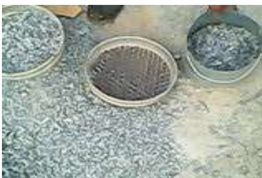
Photo 3: Tamisage de gravillon sur un tamis de 12,5 mm
