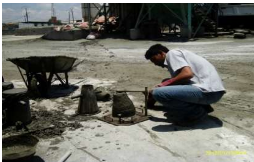
Photo 5 : Test à l'affaissement au cône d'Abrams du BO
