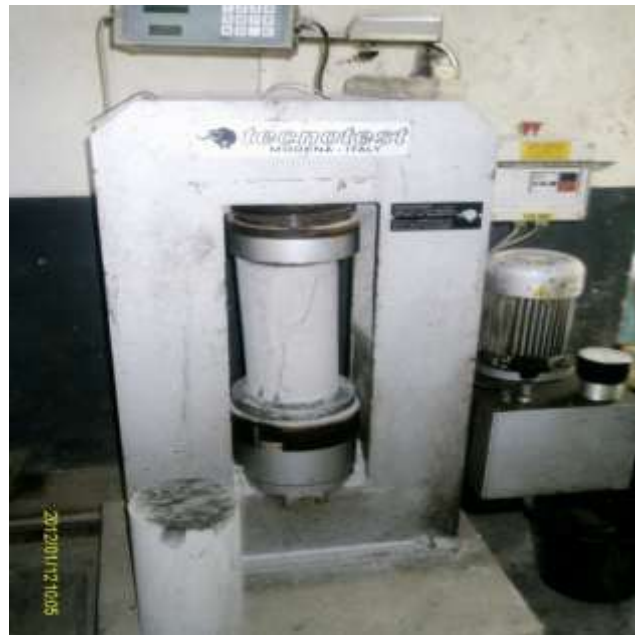
Photo 8 : Essai de compression des éprouvettes cylindriques du BFL
