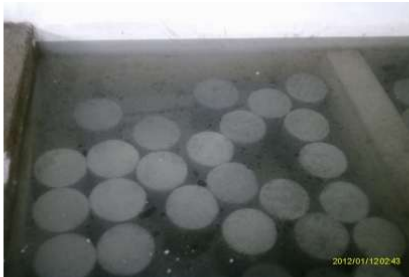
Photo 7 : Bac rempli d'eau contenant des éprouvettes cylindriques 16 *32 cm
