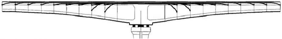
Figure 28 : Câbles de fléau en élévation
