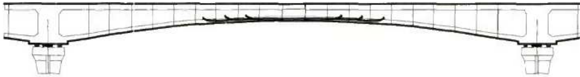
Figure 40: Câble de continuité intérieur en travée courante
