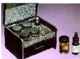
► **Liquides denses** : ces liqueurs permettent de déterminer la densité d'une pierre et cela quelles que soient ses dimensions. La densité des liqueurs varie de 2,57 à 3,52. Le principe est simple : un minéral coule dans un liquide dont la densité est moindre, par contre il restera en suspension si les densités sont égales, et flottera
