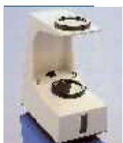
► **Le polariscope** : il suffit d'examiner la pierre, placée au-dessus d'une source lumineuse entre les deux filtres polarisants afin de séparer les pierres isotropes des anisotropes (et parfois de déceler parmi cette dernière famille les cristaux uniaxes). L'emploi du polariscope est très utilisé lors de la taille des pierres, surtout pour le diamant, car il permet de déceler les tensions internes.
