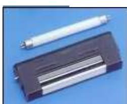
► **La lampe à ultraviolet** : cet instrument nous permettra de déterminer la luminescence/fluorescence de la pierre qui est provoquée par le rayonnement de la lumière noire.
