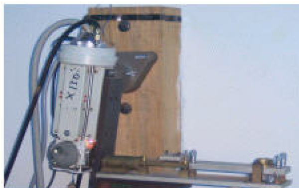
Tube à rayon X à anode en molybdène (SIEMENS type KFF, Model 4K ) Tension du tube : 40 kV
