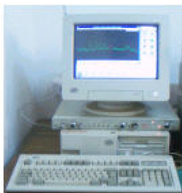
M.C.A. ( Amplificateur et Intégrateur incorporé), CANBERRA, Model 1510. Micro-ordinateur IBM 486 dans le quel sont installés les logiciels d'analyses (S100 et AXIL
