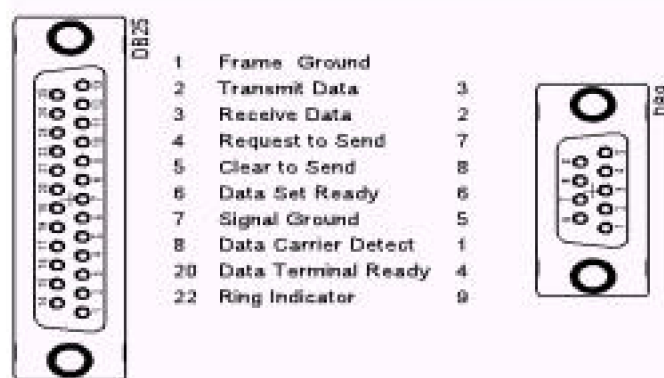
Figure 1.9 Brochages de connecteurs de la norme RS232
