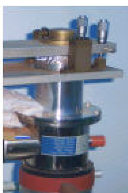
Détecteur Ultra LEGe : Model SL30180 refroidi par un Cryostat 7500, model SL 30 Préamplificateur CANBERRA, Model 2008
