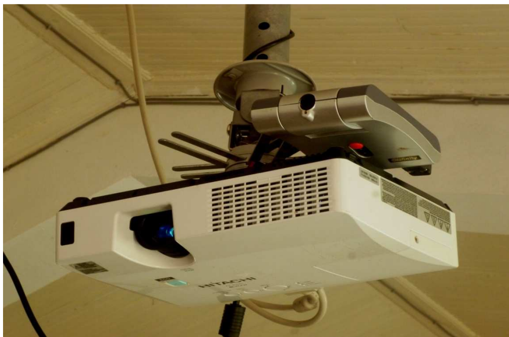
Figure 08 : TNI : Le vidéoprojecteur avec les dispositifs d'interactivité
