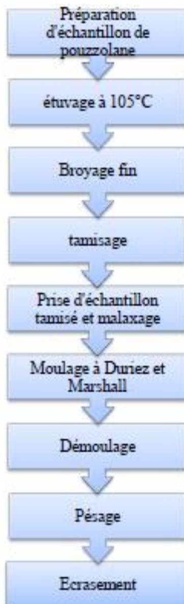
Figure 8 : Mode opératoire au laboratoire (Source : Ramanantsoa T., 2017)
