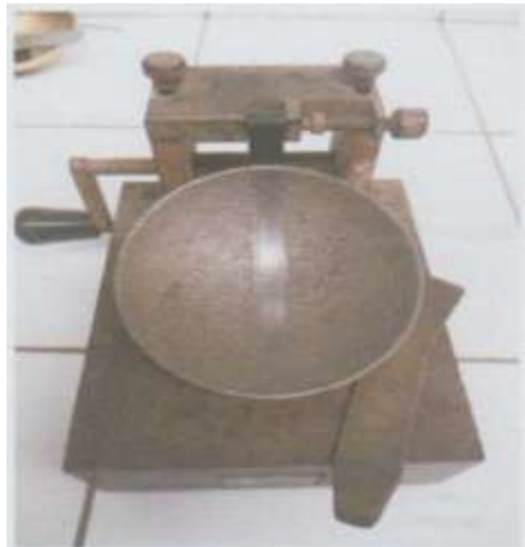
Photos 2:Appareil Casa grande pour limite d'Atterberg
