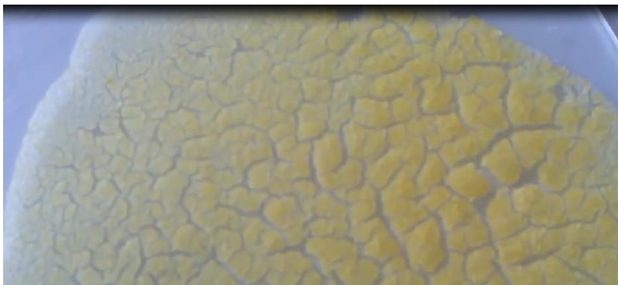
Figure 27. Film loupé avec de la farine de maïs
