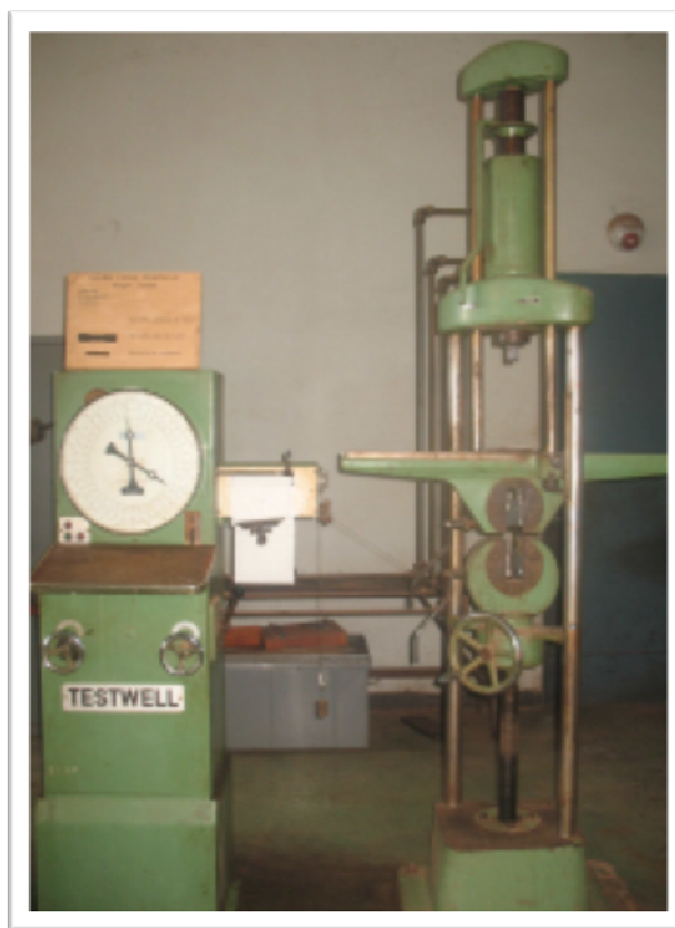
Figure 49: Presse de type TESTWELL (Appareil utilisé pour l'essai mécanique.)
