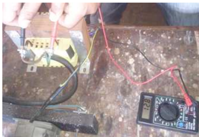
Photo. 3. La valeur de la tension donnée par le multimètre du transformateur
