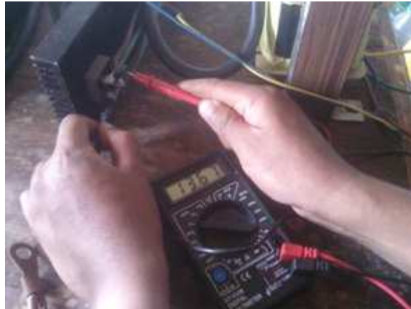
Photo. 4. La tension donnée par les deux diodes
