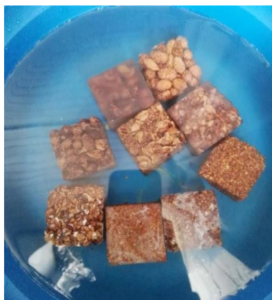
Photo 28 : Test d'humidité [auteur]
