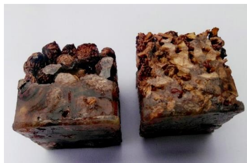
Photo 21 : Aspect des composites à 60% de noyaux entiers et concassés avec 40% de polyester [auteur]
