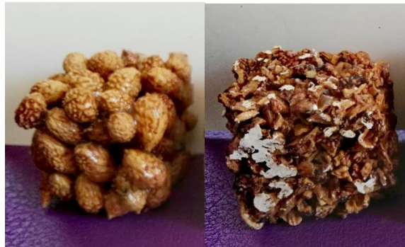
Photo 20 : Aspect des composites à 80% de noyaux entiers et concassés avec 20% de polyester [auteur]
