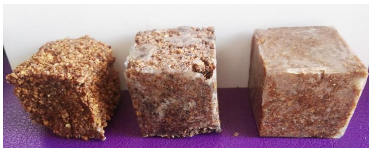
Photo 23 : Aspect des composites à 80%, 60%, 40%, de noyaux en poudre [auteur]
