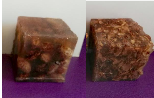
Photo 22 : Aspect des composites à 40% de noyaux entiers et concassés avec 60% de polyester [auteur]
