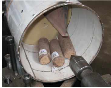
Photo 14 - Briquettes installées pour le test d'abrasion
