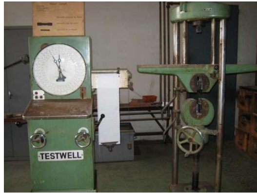
Photo 13 - Presse utilisée pour le test de compression
