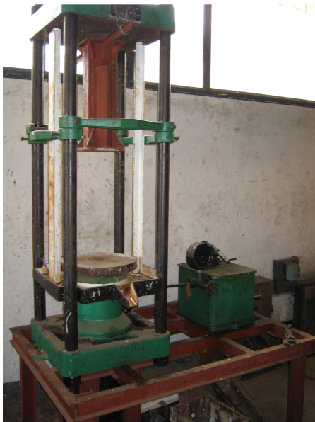
Photo 12 - Presse à manomètre du bloc technique ESPA
