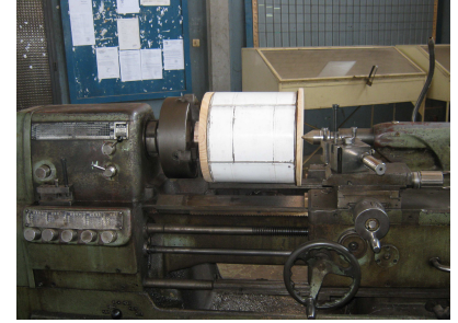
Photo 15 - Tour utilisée pour le test d'abrasion
