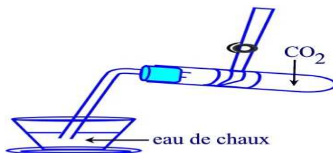
Figure 63 : Montage pour le test du gaz \text{CO}_2
