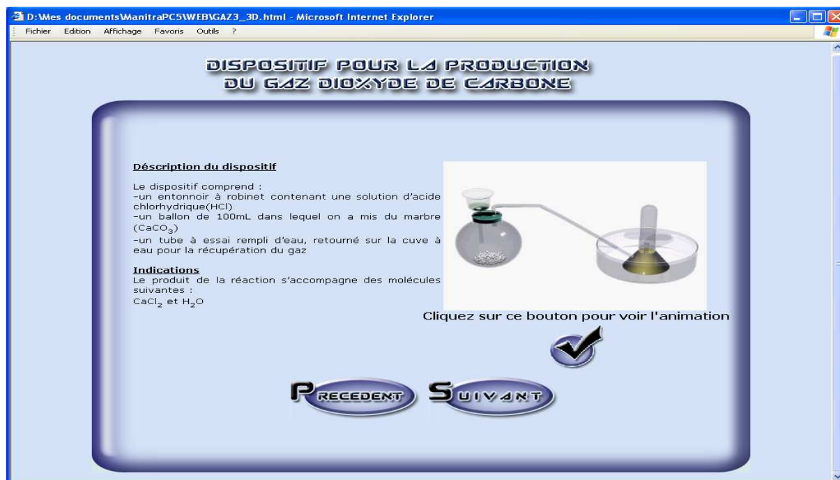
Figure 46 : Présentation du dispositif pour la production du dioxyde de carbone
