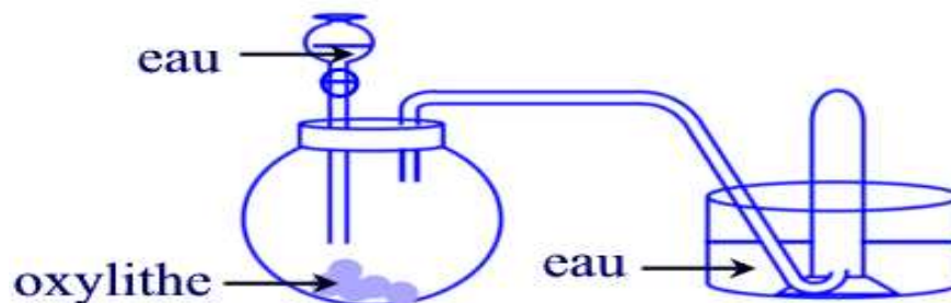
Figure 60 : Montage pour la production du gaz O_2
