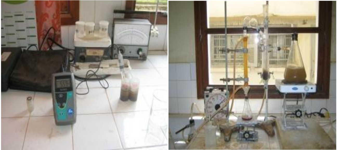
Figure 19 : Mesure du pH (à gauche) et de la CEC (Photo de l'auteur)
