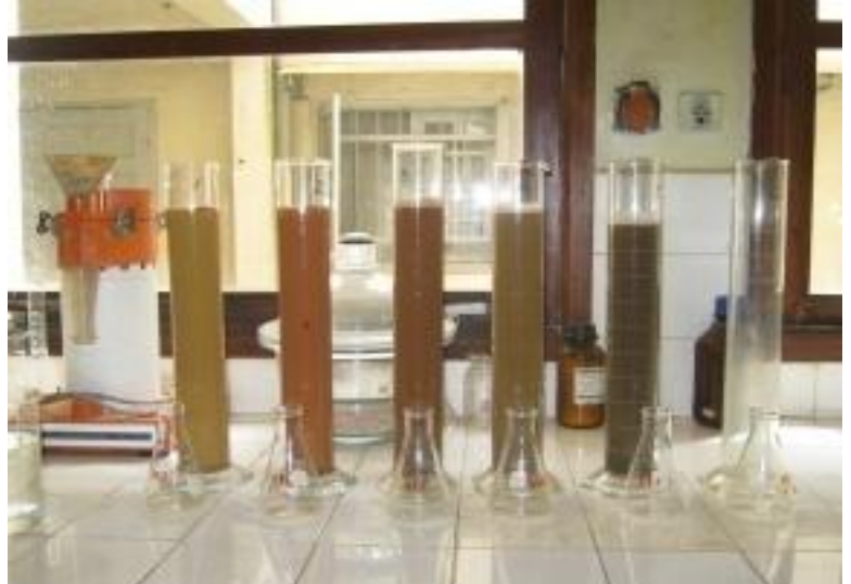
Figure 20 : Mode opératoire de l'analyse granulométrique (Photo de l'auteur)
