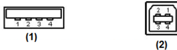
Figure 3 : (1) le connecteur « type A » et (2) le connecteur « type B »
