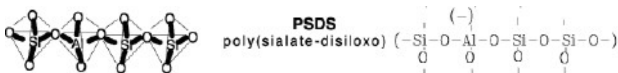
Figure 14 : Structure d'un PSDS
