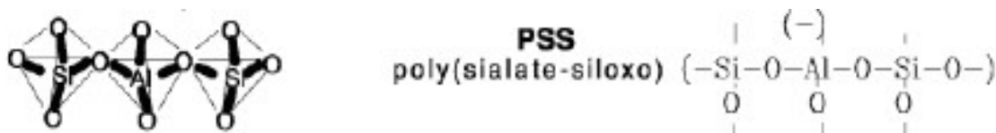
Figure 13 : Structure d'un PSS
