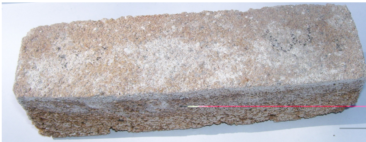
Figure 37 : Aggloméré stabilisé avec le nouveau produit
