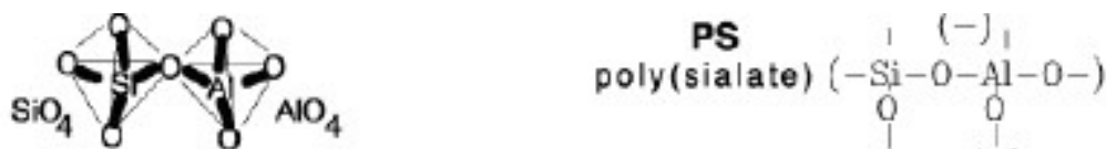
Figure 12 : Structure d'un PS
