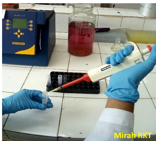
Photo 16 : Pipetage d'étalon pur dans le tube d'étalon
