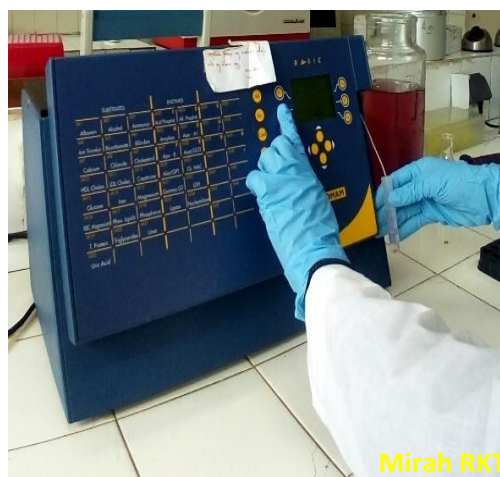
Photo 19 : Dosage des échantillons via le spectrophotomètre
