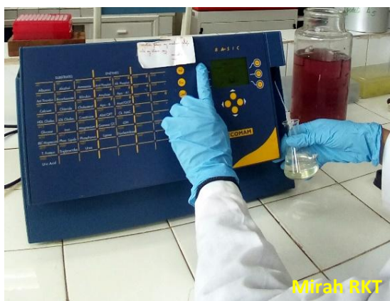
Photo 14 : Lavage du spectrophotomètre avant l'emploi
