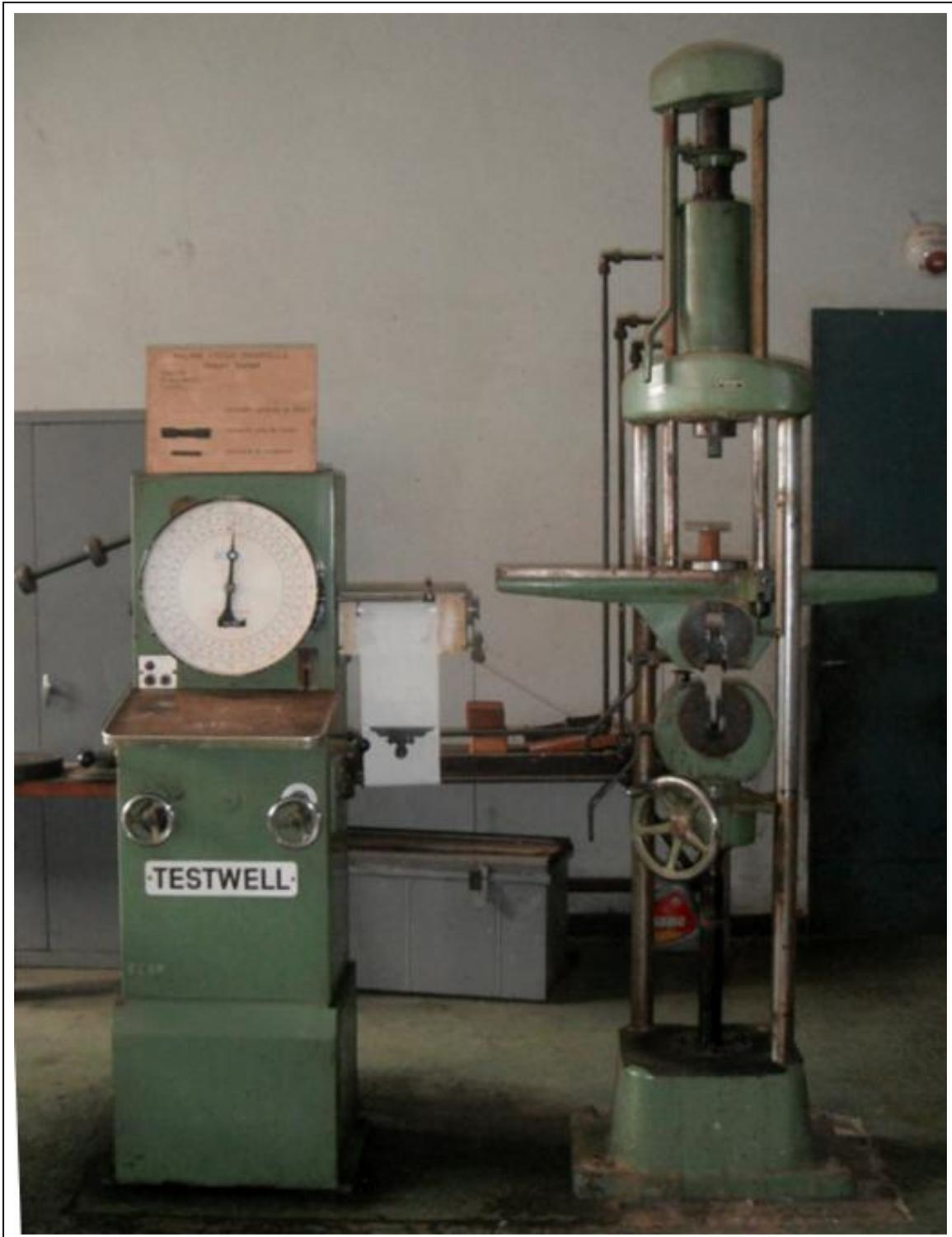
**Photo 13** : Machine TESTWELL qu'on a utilisée (avec une briquette à écraser)
