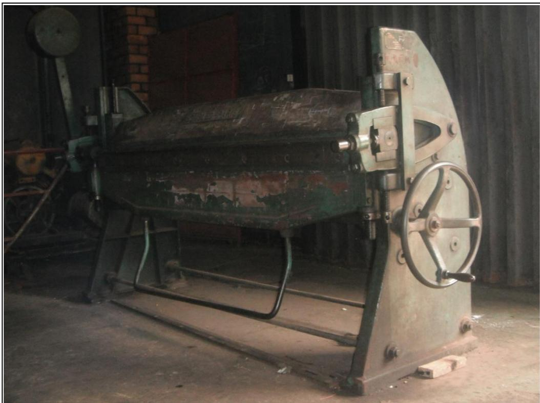
**Photo 12** : Plieuse de tôle qu'on a utilisée
