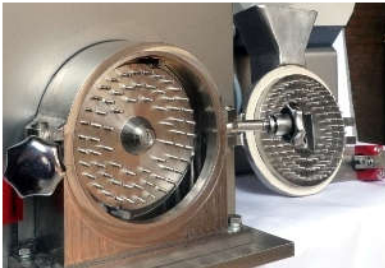
Figure 5: Schéma d'un broyeur à broches
