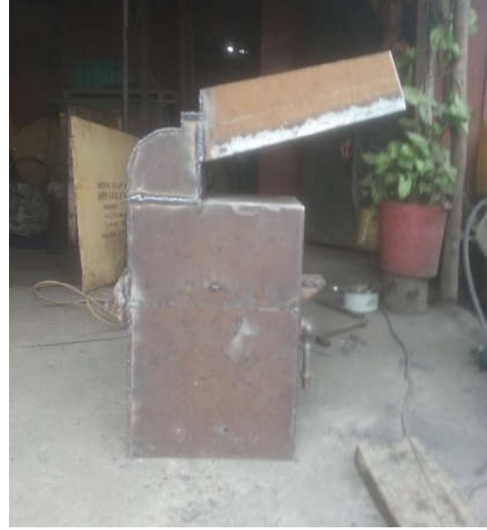
Figure 22: Chambre de broyage
