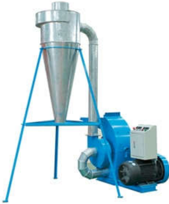
Figure 11: Illustration du système de broyage (source : Wood hammer mill, Tianjin Anson International Co., Ltd.)
