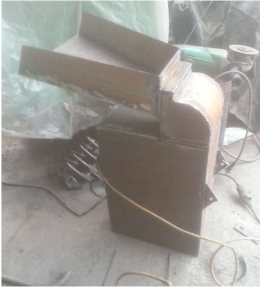
Figure 22: Chambre de broyage
