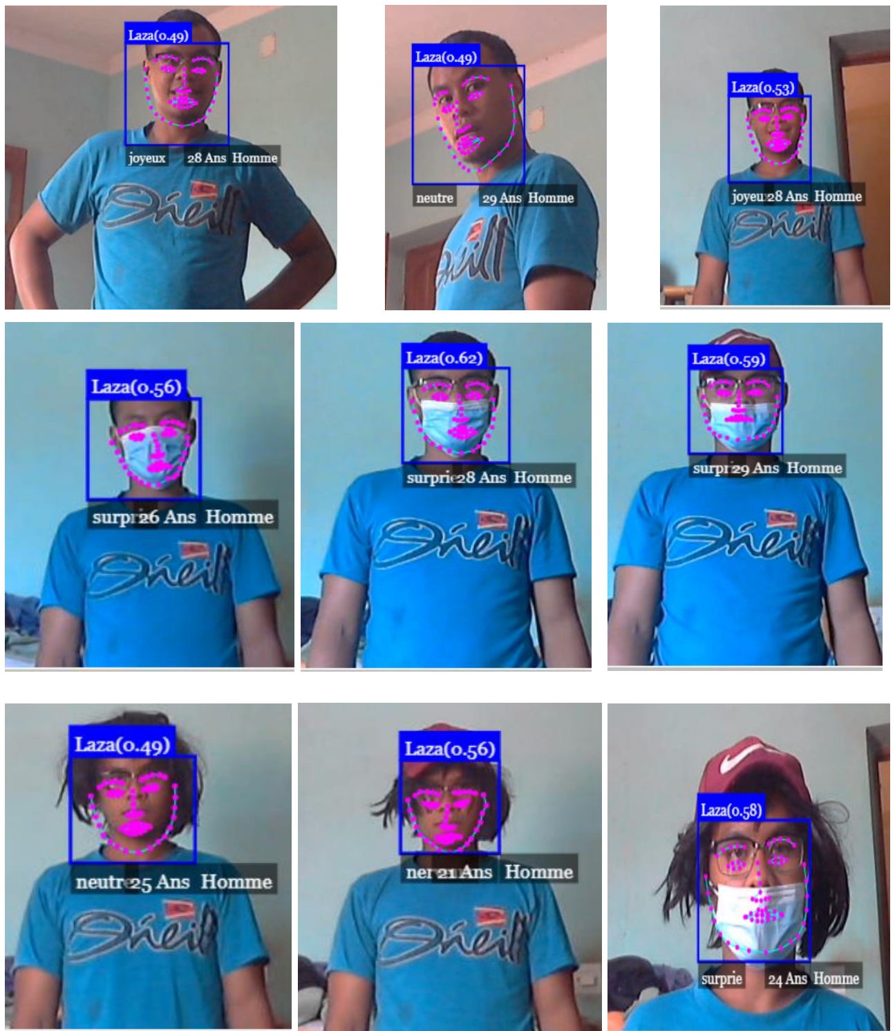
Figure 4.13 : Reconnaissance d'image faciale avec échelle et accessoire pour déformer le visage vu de face réussie
