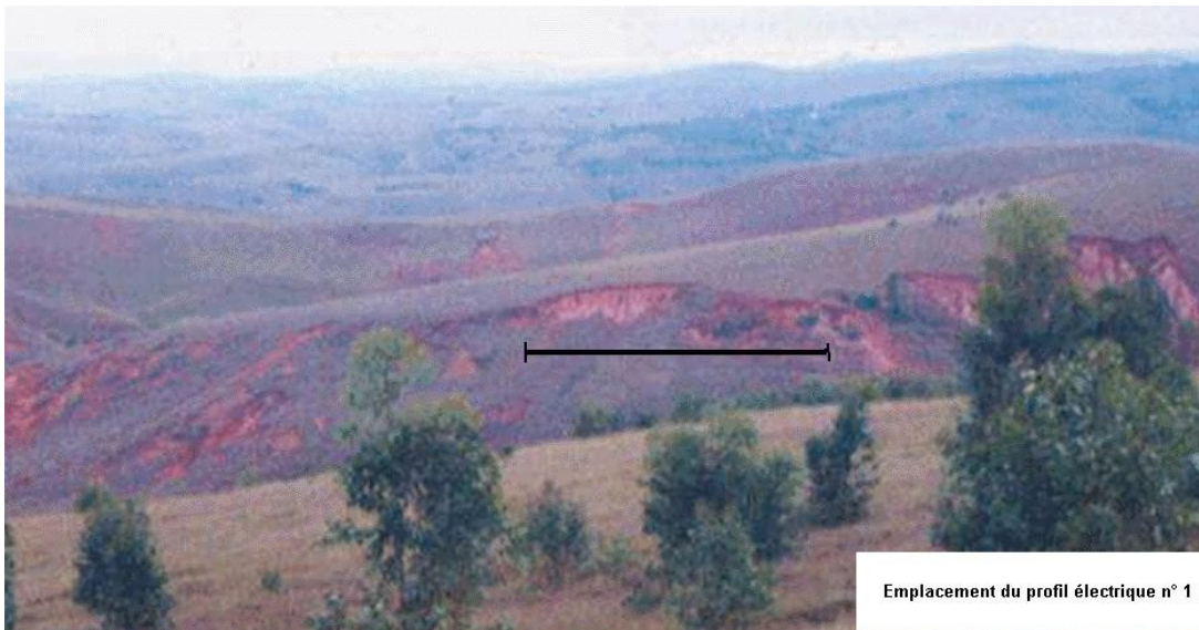
Figure 37 : Profil électrique n° 1. Le profil est placé en bas d'un glissement ayant entraîné la formation d'un lavaka.
