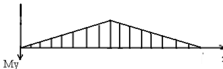
Figure 18: Diagramme des moments suivant Oy pour l'arbre du pignon (2)
