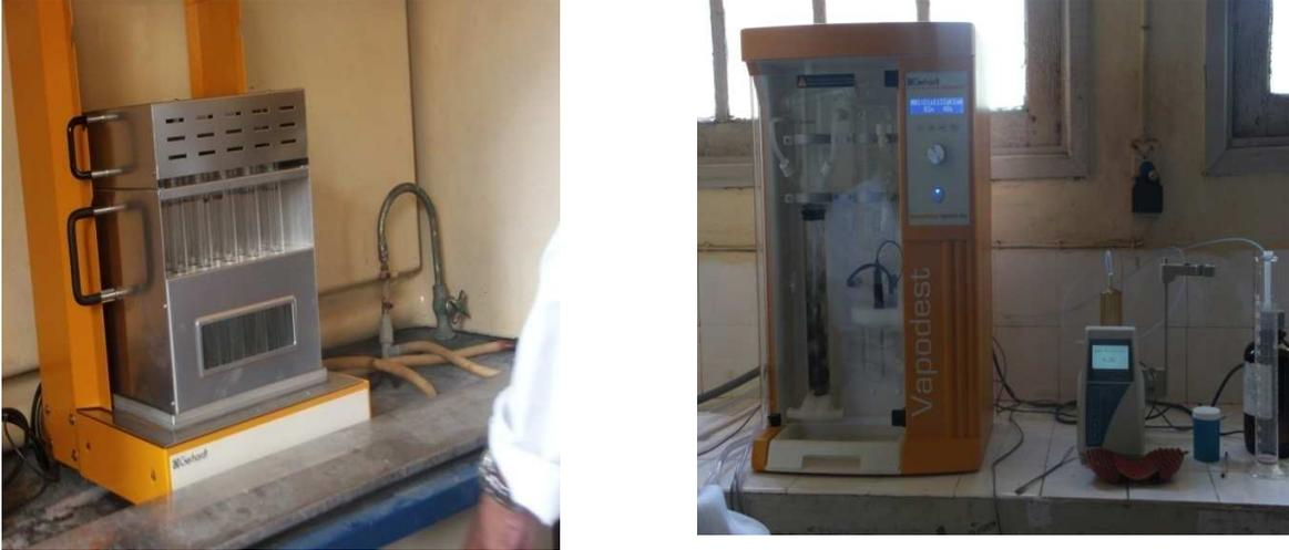
Figure 43 : Appareils de mesure de l'azote
