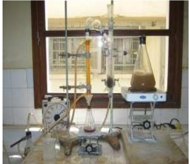
Figure 41 : Appareils de mesure du pH (à gauche) et de la Capacité d'Echange Cationique (à droite)
