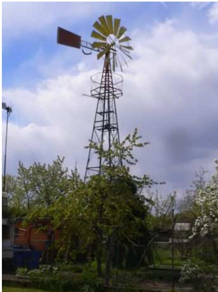
**Figure 01:** éolienne a axe horizontal
