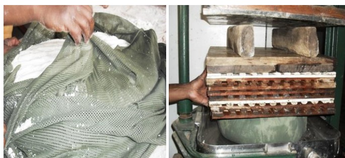
Figure n°12 : Pressage des pulpes de manioc, (Cliché : auteur, 2011)
