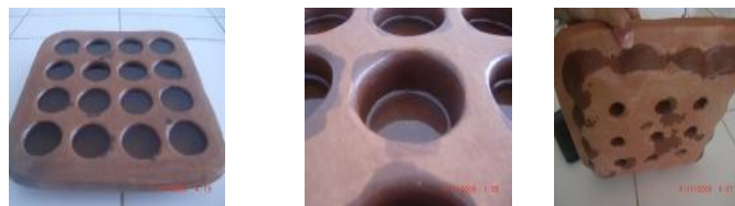
Figure n°5 : Trempage du moule par de l'huile, (Cliché : auteur, 2011)
