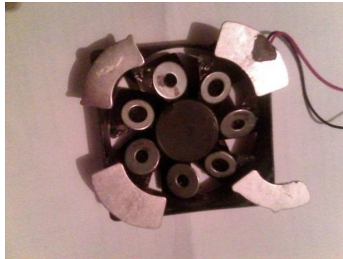
Figure 3.6 Mise en place des aimants alnicos et des aimants néodymes
