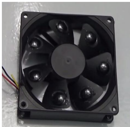
Figure 3.7 : Mise en place des aimants ferrites sur les pales
