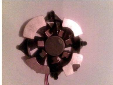
Figure 3.8 : Mise en place des aimants samariums cobalts et des aimants néodymes
