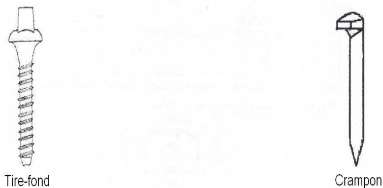
Figure 7: Les éléments de fixation des rails sur traverse en bois
