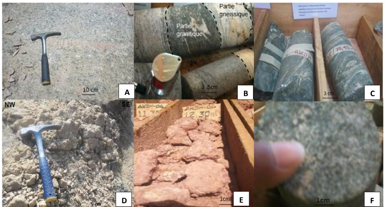
Figure 8 : Les roches métamorphiques (A= Migmatite granitoïde B= Carotte de migmatite montrant une partie granitique et une partie gneissique, C= Carottes de gneiss, D= Quartzite fissuré, E= schiste fraîche, F=Carotte de schiste altérée)
