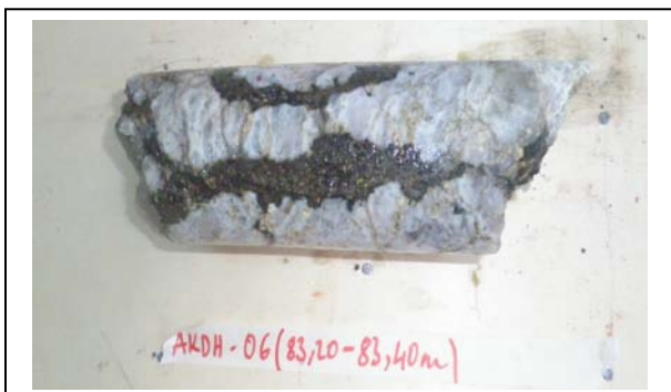
Figure 31 Photo montrant une fracture dans un quartzite remplacée par les biotites.
