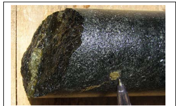
Figure 32 Photo montrant des veinules des minéraux sulfurés dans une amphibolite.
