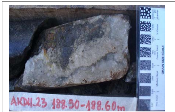
Figure 29 Photo montrant des gains de quartz recristallisés et remobilisés dans le gneiss
