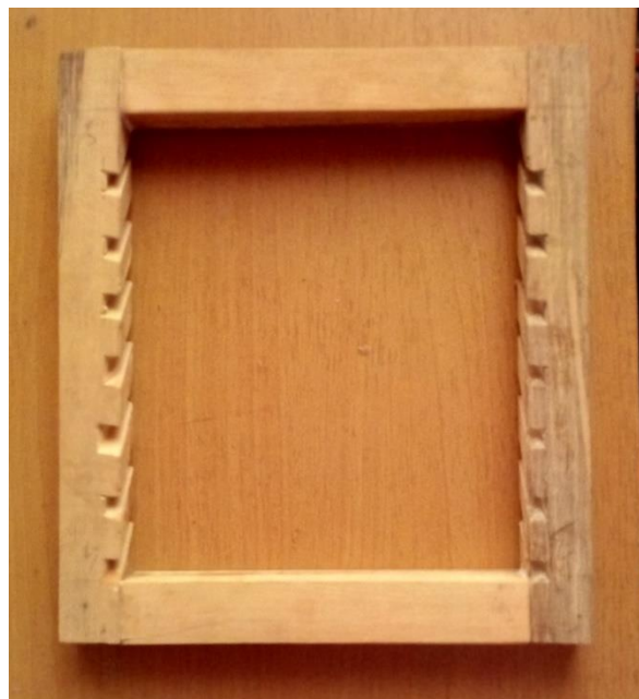
Photo III. 2 : Montage des traverses et montants Amboropotsy Talatamaty, 15/10/2019
