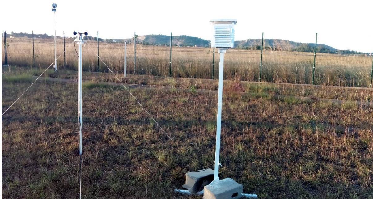
Photo III. 16 : Abri placé dans un parc météorologique Parc météo ASECNA Ivato, 20/10/2019
