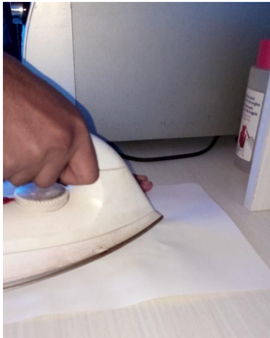
Photo III. 9 : Repassage au dos du papier glacé Amboropotsy Talatamaty, 16/10/2019
