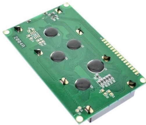
Figure B. 2 : LCD 20x4 Dos Source : Lextronic, Note d'utilisation version 1.0 /20-12-2006
