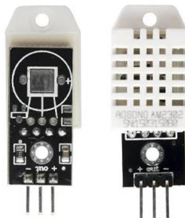
Figure II. 8 :DHT22 capteur de température et humidité
