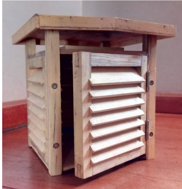
Photo III. 5 : Abri après montage des cloisons et du toit. Amboropotsy Talatamaty, 15/10/2019
