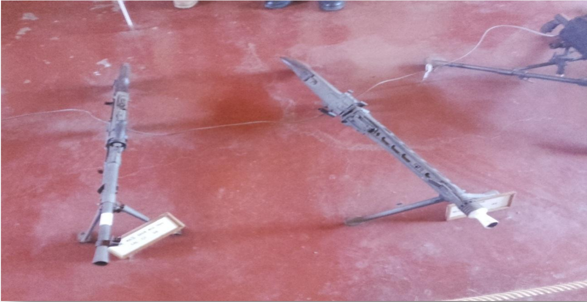
Figure 15 : Mitrailleurse Kalachnikov, munition 7,62x54mm, avec une masse de 8,99kg, année 1961
