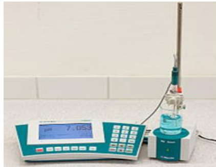
Figure 1-2 Schéma d'un pH-mètre muni d'une sonde de température [4]
