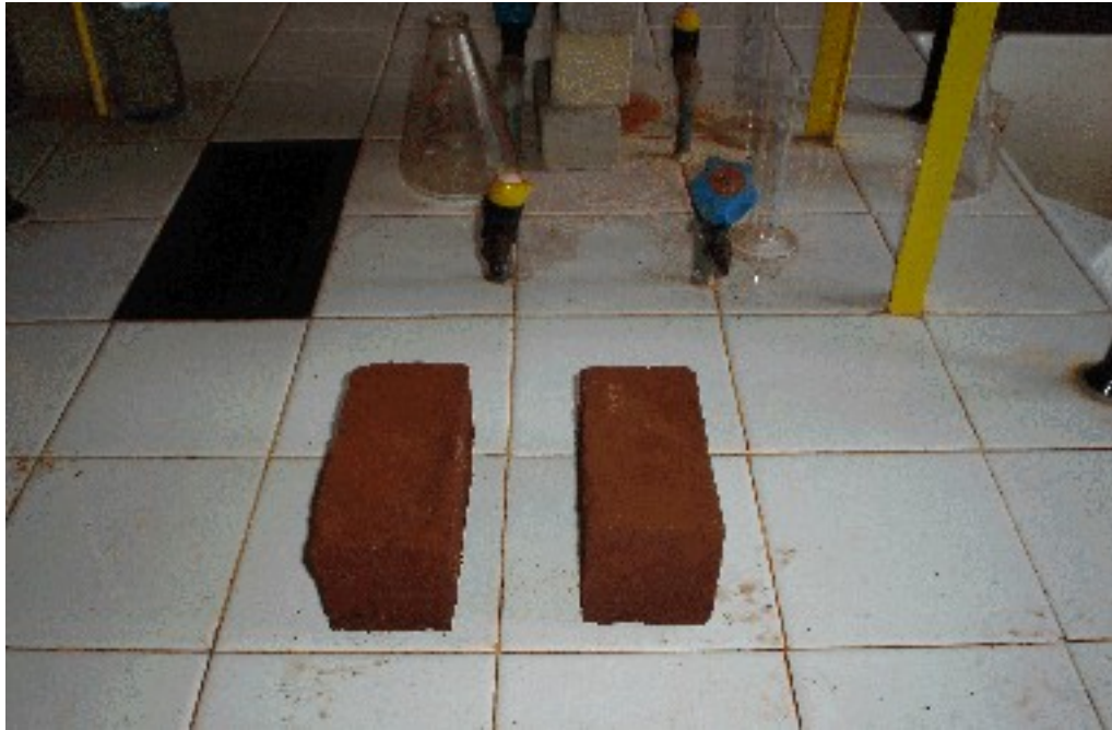
PHOTO 07 : Briques stabilisées au résine minérale
