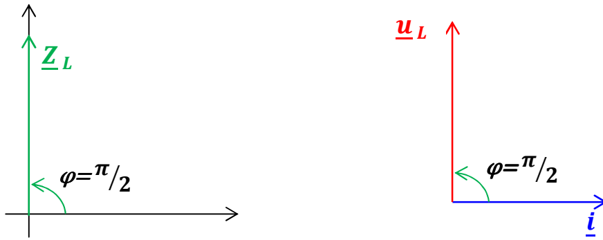
Figure 10 : Diagramme de Fresnel associé à une inductance L
