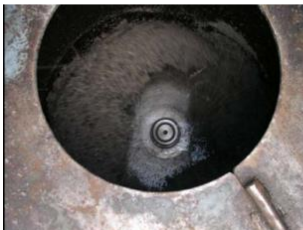
Figure 8.02 : Broyage des déchets plastiques
