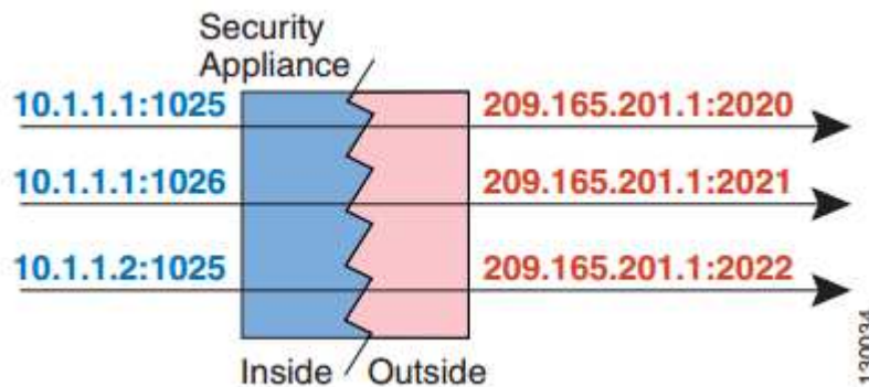
Figure 2.0 8 : Principe du PAT.
