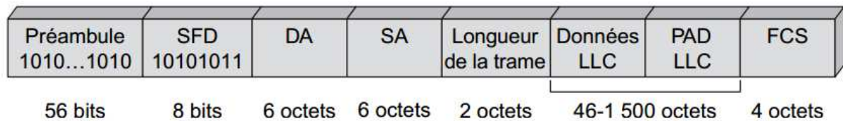
Figure 1.0 9 : Format de trame Ethernet de l'IEEE.
