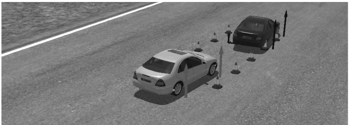
FIGURE 6.24. Les deux véhicules exécutant de test ISO 3888-2 modifiée dans l'environnement simulé de CarSim
