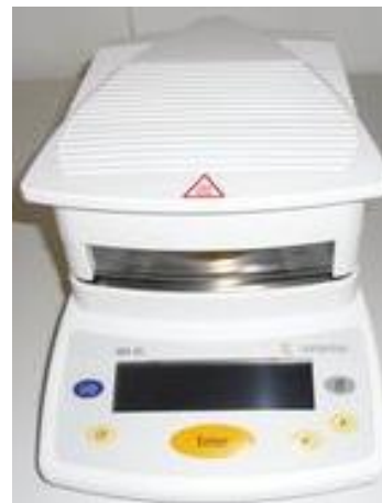
Figure 23: Humidimètre Sartorius® MA 45 (Labexchange, 2013)
