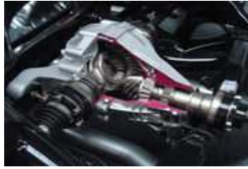
Fig. : 10 (Ensemble d'engrenages dans un différentiel (Porsche Cayenne))
