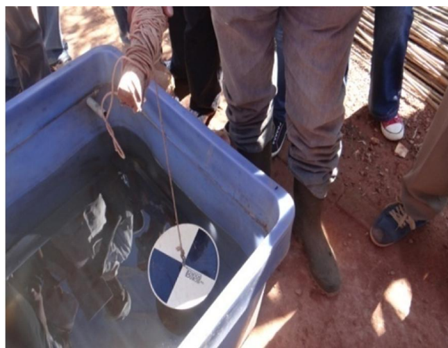
Figure 5 : Evaluation de la transparence de l'eau d'un bassin à l'aide d'un disque de Secchi
